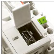
Сервисный порт USB предназначен для обновления прикладного и системного ПО контроллера, обновления микропрограмм модулей ввода-вывода контроллера.
