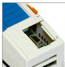
Разъем вспомогательного интерфейса RS-232C предназначен для обновления прикладного и системного ПО контроллеров, обновления микропрограмм модулей ввода-вывода контроллера.
