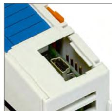
Разъем вспомогательного интерфейса RS-232C предназначен для обновления прикладного и системного ПО контроллеров, обновления микропрограмм модулей ввода-вывода контроллера.
