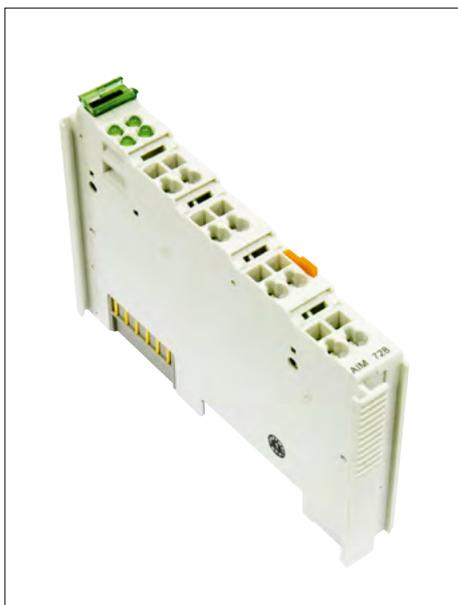
Внешний вид типового модуля ввода-вывода
