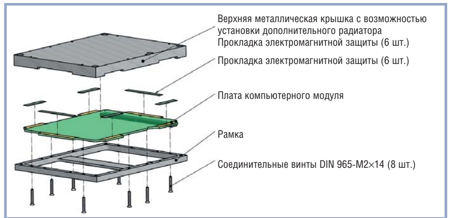
Рис. 5. Схема сборки КМ Men Micro ESMexpress™ и деталей корпуса с пластиной-теплораспределителем согласно стандарту ANSI-VITA 59
