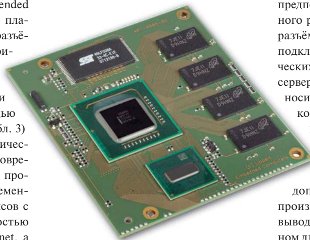
Рис. 8. КМ спецификации CoreExpress™ ECO компании Lippert
