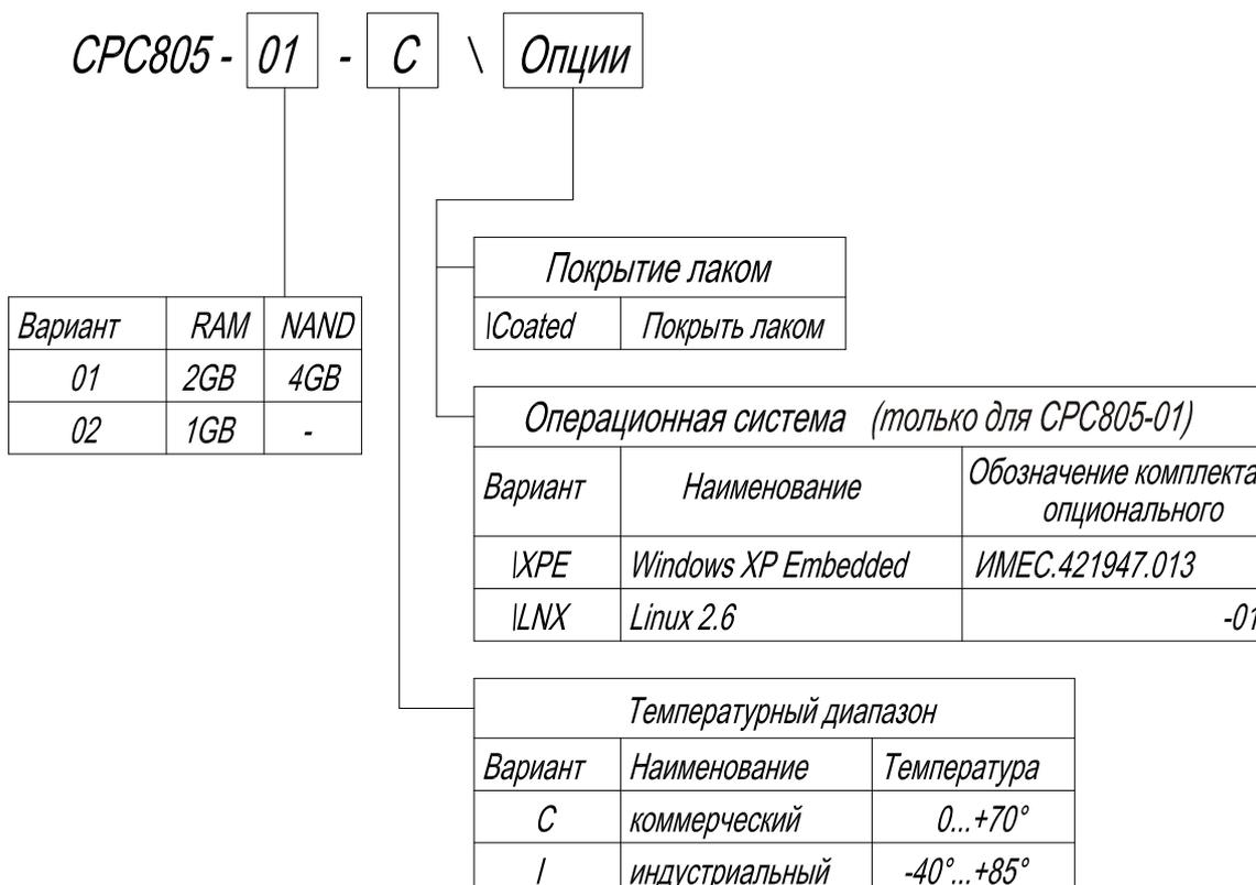
**ФУНКЦИОНАЛЬНАЯ СХЕМА CPC805**
