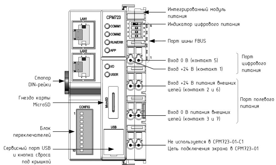
Предназначен для применения в составе программируемых логических контроллеров с переменным составом модулей Fastwel I/O в качестве модуля центрального процессора.
