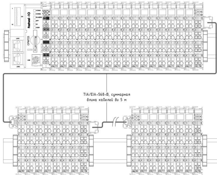
К программируемому контроллеру CPM723 через удаленные порты межмодульной шины FBUS на базе двух интерфейсных модулей NIM745-01 может быть дополнительно подключено до 128 периферийных модулей.
