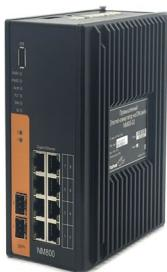
Для организации взаимодействия ПЛК Fastwel по сети Ethernet между собой, а также с другими устройствами в рамках единой АСУ ТП рекомендуется использовать управляемые коммутаторы Fastwel NM800, обеспечивающие построение надежных, отказоустойчивых и мультисервисных сетей передачи данных, функционирующих в неблагоприятных условиях окружающей среды.
