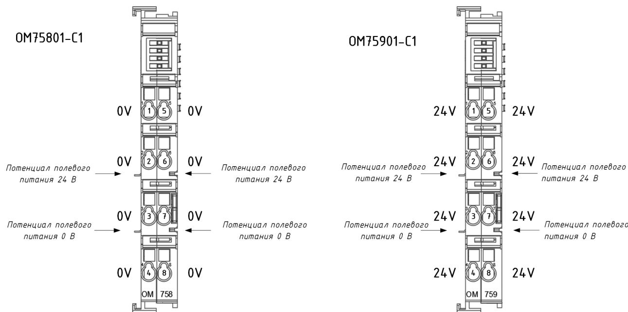
Модули ОМ758 и ОМ759 предназначены для размножения потенциалов напряжения шины полевого питания и обеспечения возможности реализации двухпроводной схемы подключения датчиков к однопроводным каналам модулей ввода-вывода.
