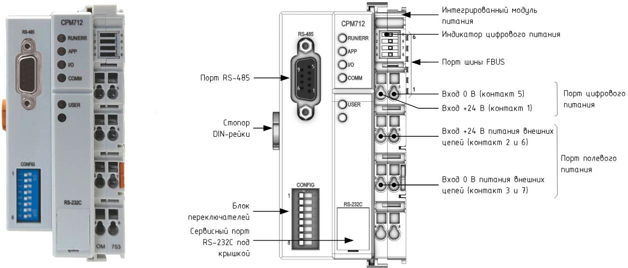
Предназначен для управления модулями ввода-вывода Fastwel I/O в системах сбора и обработки данных, построенных на базе интерфейса RS-485 и протоколов прикладного уровня Modbus RTU и DNP3.
