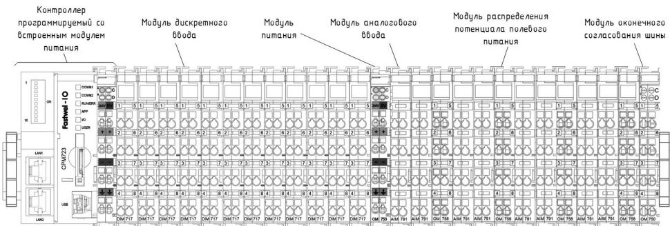
Конфигурация ПЛК может включать в себя несколько смежных наборов периферийных модулей, размещаемых в пределах одного шкафа или другой оболочки и соединенных стандартными кабелями TIA/EIA-568-B (патч-корд).
