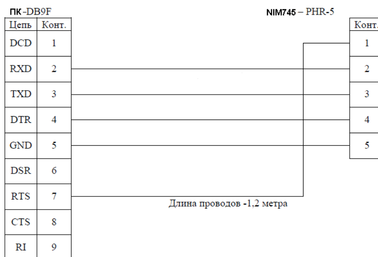
Рис. 2 Таблица соединений на кабель последовательного интерфейса RS232
