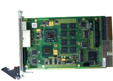
Рис. 8. Процессорная плата F19P формата 3U CompactPCI® PlusIO компании MEN Mikro Elektronik GmbH
