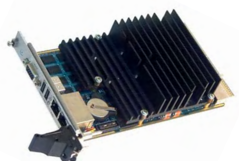
Рис. 10. Процессорная плата CPC506 CompactPCI 3U (PICMG 2.30) на базе процессоров семейства Intel Core 2 Duo (частота до 2,2 ГГц) с 2xGigabit Ethernet и Serial ATA
