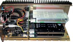
Рис. 3. Бортовой вычислительный комплекс с кондуктивным охлаждением
