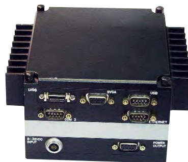
Рис. 7. Защищённые компьютеры HiDAN (слева) и IDAN (справа) компании RTD Embedded Technologies
